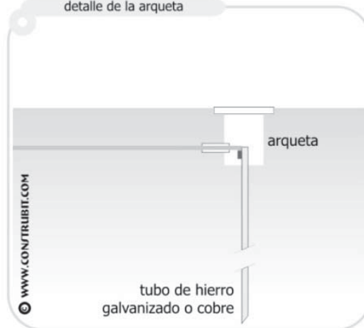
detalle de la arqueta
