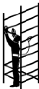
USAR CINTURÓN EN MONTAJE Y DESMONTAJE
