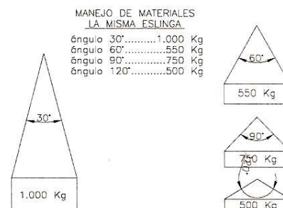
Relación entre el ángulo de la eslinga y su capacidad de carga
