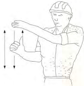
4.- LEVANTAR EL AGUILÓN O PLUMA LENTAMENTE
