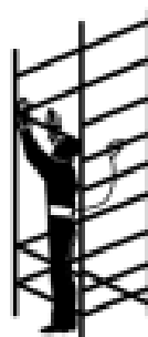
USAR CINTURÓN EN MONTAJE Y DESMONTAJE
